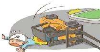
헤드가드와 바닥 사이에 끼임
